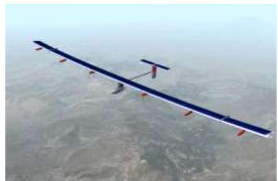
Der Solarflieger hat mit 64 Metern die Spannweite einer Boeing 777 und ist mit 12.000 Solarzellen bestückt. Er wird von vier Elektromotoren angetrieben. Da das Flugzeug mit einer Geschwindigkeit von nur 70 Stundenkilometern sehr langsam ist und die Aufwinde nicht zu stark sein durften, war die Landung in Zaventem in die Abendstunden gelegt worden.
