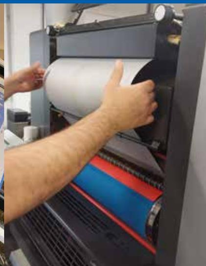
Insertion des plaques sur cylindres d'offset pour impression test
